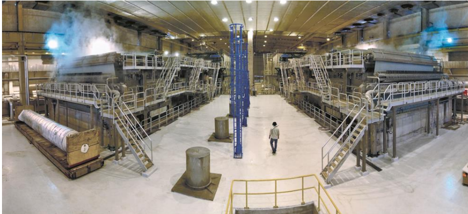
ANDRITZ-Zellstofftrocknungslinie
